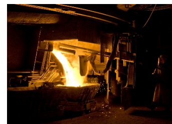
Heiße Sache: beim Abstich hat das Carbid eine Temperatur von 1.700 °C.
